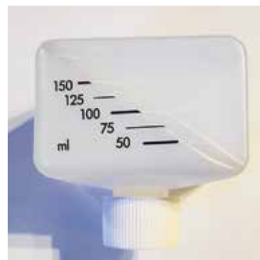
Abb. 21: Die neue Flasche des Liebig-Dispensers mit aufgeklebter Skala.
